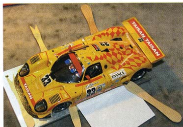
Eventuell hilft ein Gewicht, beim Abbinden des 2K-Klebers, um die Karosserie in Position zu halten.
