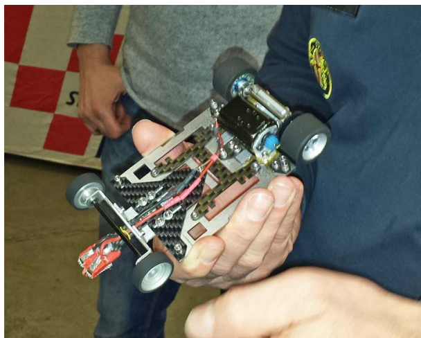
Jürgens T74 mit selbstkonstruierter Hinterachsfederung . . .
