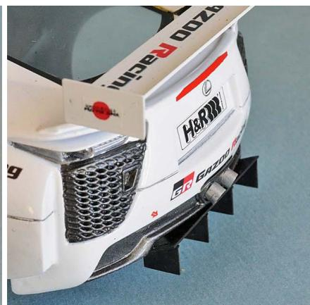
Positionierung: Die hintere Diffusorkante schließt in der Fahrzeugmitte mit der äußereren Karosseriewölbung ab (vgl. Foto rechts).
