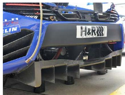
Positionierung: Die hintere senkrechte Diffusorkante sitzt direkt hinter der Heckblende.
