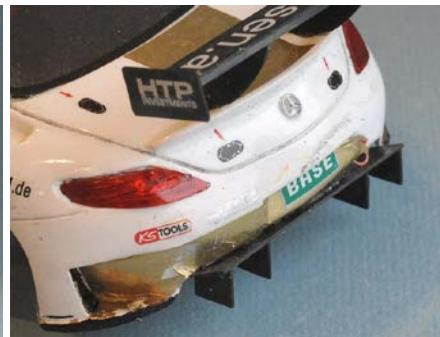
Positionierung: Die hintere Diffusorkante schließt in der Fahrzeugmitte mit der „Nummernschildplatte“ ab (vgl. Foto rechts/ vom JM Modell).
