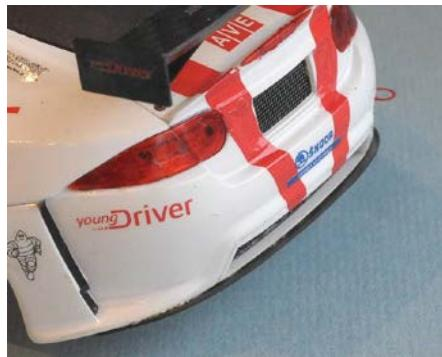
„Diffusor“ wird direkt (stumpf) unter die Karosserie geklebt – dient lediglich zur Verstärkung der Heckpartie!
