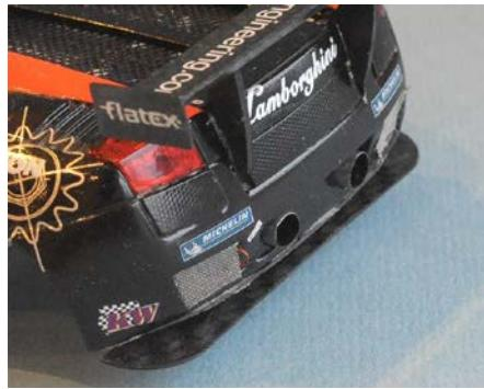
„Diffusor“ wird direkt (stumpf) unter/ in die Karosserie geklebt.
