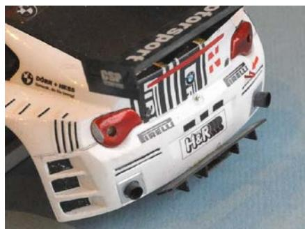
Einzelne „Hilfsplatte“ wird unter die zwei inneren, senkrechten Stege sowie die Deckplatte des Diffusors geklebt. Damit ergibt sich die korrekte Neigung.
